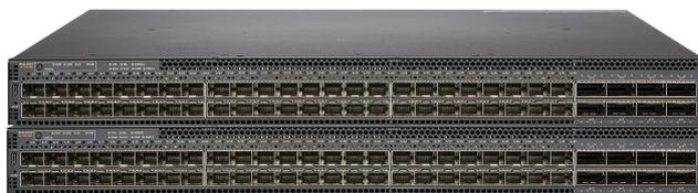
Ruckus® ICX® 7850 可堆疊彙總 匯聚交換器提供 1/10 GbE 和 1/10/25 GbE 機型。兩種機型均配有 8 個 40/100 GbE 連接埠，供堆疊或上行流量使用。1/10 GbE 機型提供 48 個 1/10 GbE 連接埠及 MACsec 和 LRM 功能；1/10/25 GbE 機型提供 48 個 1/10/25 GbE 連接埠，以及 8 個可供上行流量或堆疊使用的 40/100 GbE 連接埠。這些交換器以要求嚴苛的企業客戶為主要目標客群，這類客戶通常需要高效能、高可靠性的彙總/核心交換器，或是將交換器直接部署於資料中心的機架上使用。
