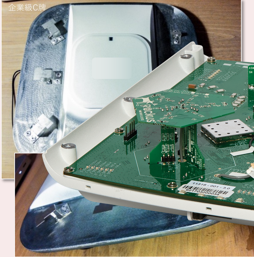
平面型倒F天線(Planar inverted-F antenna)(簡稱 PIFA)
